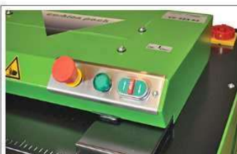
Elementos operativos y dispositivo de parada de emergencia en el CP 422 S2
